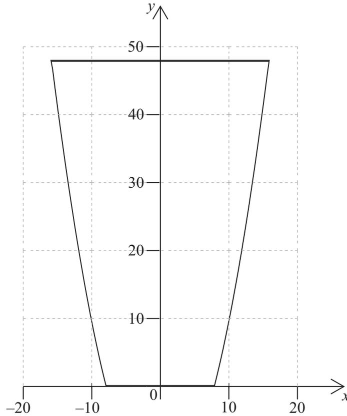
Los lados curvos de dicha sección transversal vienen dados por la ecuación  $y = 0,25x^2 - 16$ . Las secciones transversales horizontales son circulares. El contenedor tiene una altura de 48 cm.
